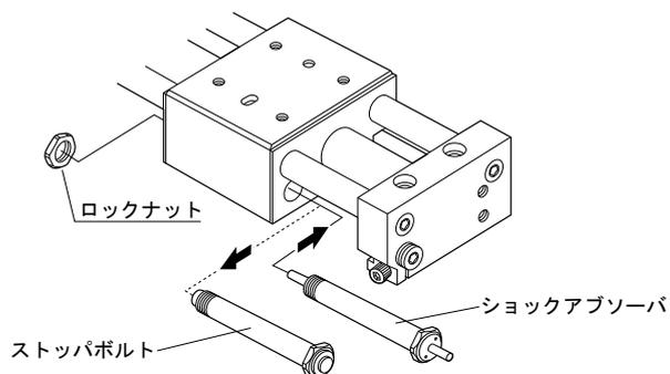
1. ストッパボルト固定用ロックナットを外してください。
