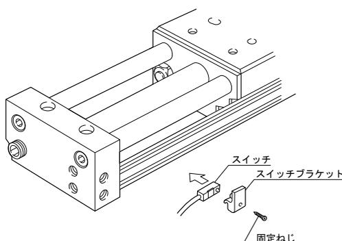
1. スイッチブラケット固定ねじを緩めスイッチに取付けてください。
