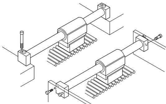
6. スタンダード形は、スライダが自由に回転しますので、図のように必ずマウント金具を使用してください。
