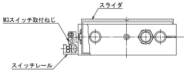
1. スイッチ取付けねじをゆるめて、スイッチの表示灯が点灯（ONする）開始する位置よりさらに2~5°（動作範囲の約半分が適切です）手前から検出するようにスイッチを移動させ、スイッチ取付けねじをしめて固定します。
