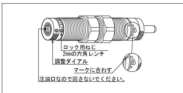
ショックアブソーバに負荷が衝突して、ピストンロッドがボトミングを発生するときは、調整ダイアルを大質量方向に回転させてください。また、ストローク途中で停止するときは、小質量方向に回転させてください。
