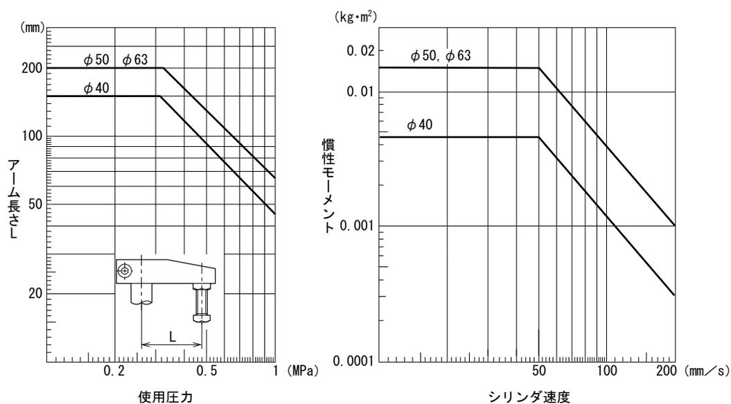
【注意】ピストンロッド端面のめねじを使用してアームを取付の場合は、表の圧力以下でご使用ください。
