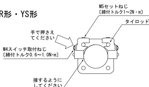
1. 2本のセットねじを六角レンチでゆるめてタイロッドにそって移動させます。
