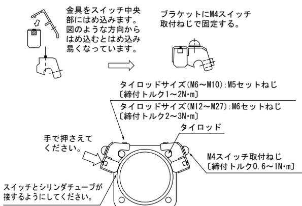
1. 2本のセットねじを六角レンチでゆるめてタイロッドにそって移動させます。
