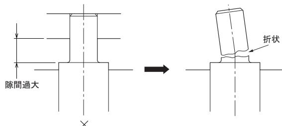
トラニオンと相手軸受けとの隙間をできるだけ小さくして取付てください。また、軸受けとピンとの間に曲モーメントがかからないよう軸芯を一致させて取付てください。
