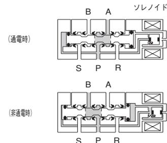
ソレノイドに通電するとパイロット圧が排気されて、スプールは右側へ移動してP→Aにエアが流れます。通電を切るとパイロット圧が供給されて左右のピストンの面積差によってスプールは左へ移動してP→Bに切り換わります。停電時、電気回路遮断時には非通電時の位置に戻ります。
