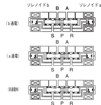
ソレノイドaに通電するとパイロット圧が排気されてスプールは左側へ移動してP→Aにエアが流れます。ソレノイドbに通電した場合にはP→Bに切り換わります。停電時、電気回路遮断時にはその位置を保持します。
