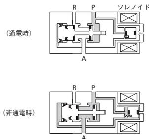
ソレノイドに通電するとパイロット圧が排気されてスプールは右側へ移動してP→Aにエアが流れます。通電を切るとスプールが左側へ移動してP圧はクローズされます。停電時、電気回路遮断時には非通電時の位置へ復帰します。
