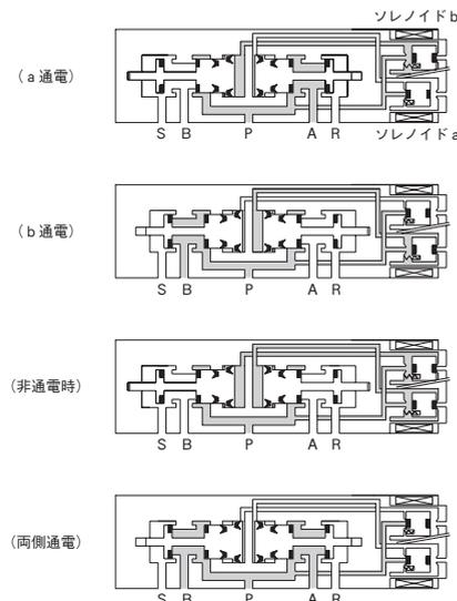
ソレノイドaに通電するとパイロット圧が排気されて右側のスプールが左へ移動してP→Aにエアは流れます。ソレノイドbに通電するとP→Bに切り換わります。通電を切った場合には両側のスプールが外側へ移動してA・Bポートは排気状態になります。両側ソレノイドに通電した場合にはA・Bポートは加圧状態になります。
