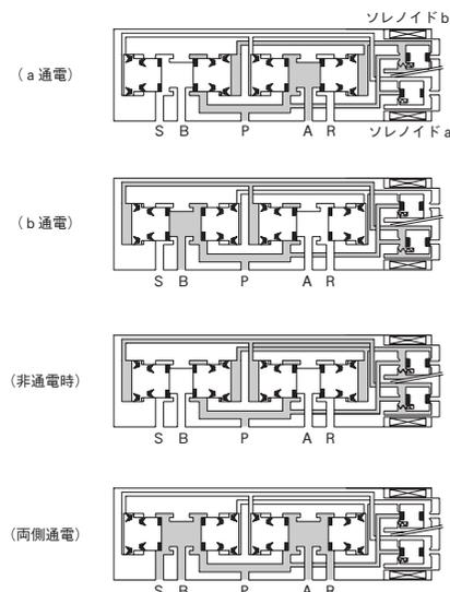
ソレノイドaに通電するとパイロット圧が排気されてピストン2個が左へ移動してP→AとB→Sの通路が開きます。ソレノイドbに通電するとP→Bに切り換わります。通電を切った場合には全部のピストンにパイロット圧が流れて、A、Bポートはクローズ状態になります。両側ソレノイドに通電した場合には、全部のピストンへのパイロット圧が排気されてPポートからの供給圧力はA、B、R、Sポートへ流れます。
