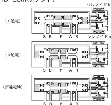
ソレノイドaに通電するとパイロット圧が排気されてスプールは左側へ移動してP→Aにエアが流れます。ソレノイドbに通電した場合にはP→Bに切り換わります。停電時、電気回路遮断時にはその位置を保持します。
