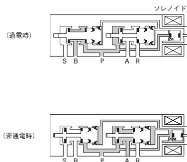
ソレノイドに通電するとパイロット圧が排気されて、左右のスプールが右側へ移動してP→Bにエアが流れます。通電を切るとパイロット圧が供給されて左右のスプールが左側へ移動してP→Aに切り換わります。停電時、電気回路遮断時には非通電時の位置に復帰します。
