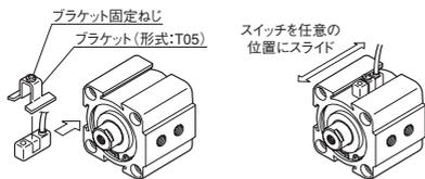
1. シリンダストローク端検出の場合は、スイッチのコード部が、シリンダ中央側へ向くようにしてください。
