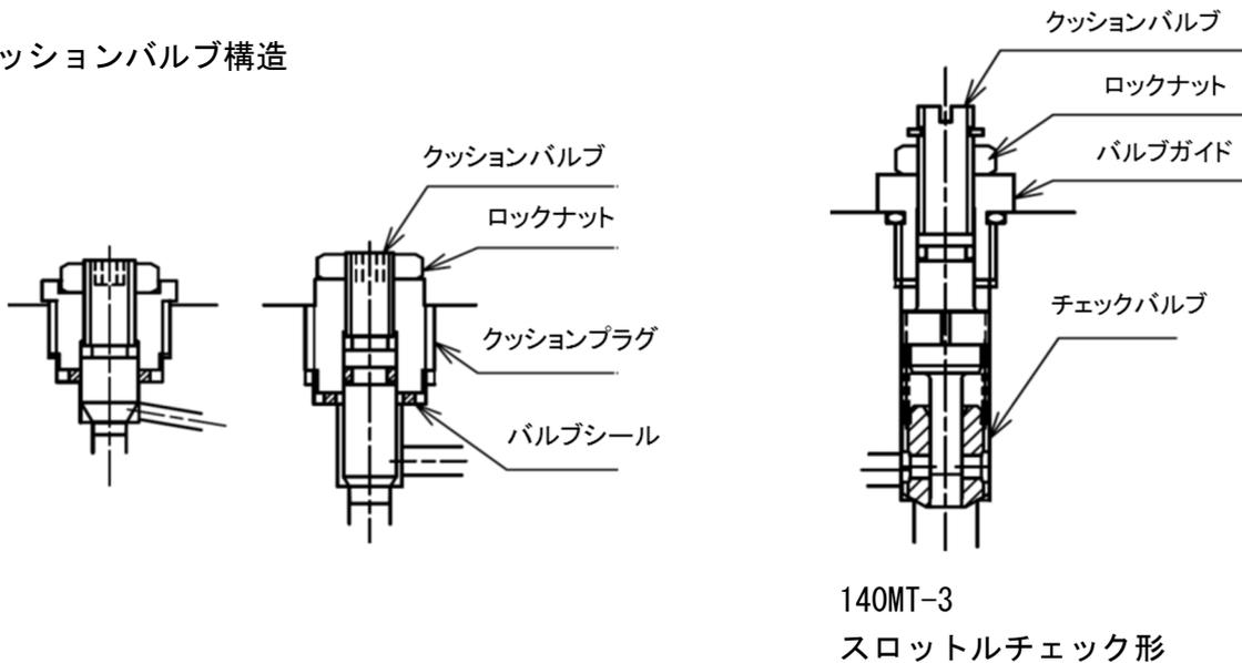
ピストン速度を 50mm/s 以下の低速から徐々に上げながらクッションを調整してください。
