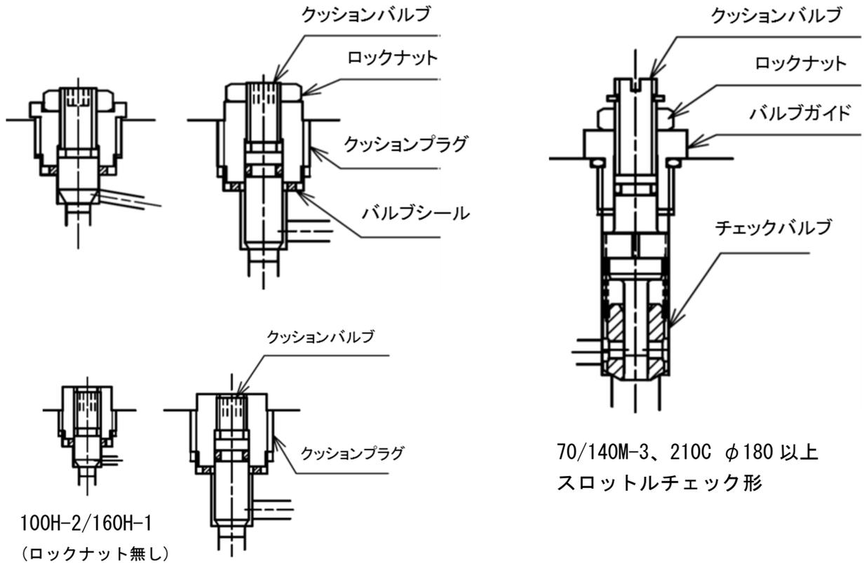
ピストン速度を 50mm/s 以下の低速から徐々に上げながらクッションを調整してください。
