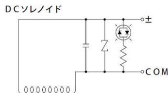
◆ D1VWソレノイドバルブは端子箱上の4箇所のビスを外し結線を行ってください。ソレノイドaを駆動させるときはC端子とA端子に、ソレノイドbを駆動させるときはC端子とB端子にそれぞれ結線してください。アース配線が必要な場合はアース端子をご利用ください。
