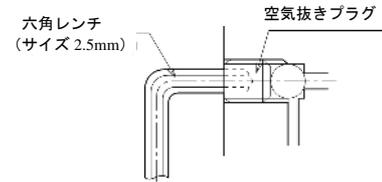
※シリンダに低圧(シリンダが低速 10mm/s 位で動く程度の圧力)の油を送り、油中の空気を空気抜きプラグから抜いてください。
