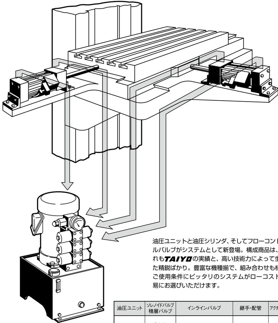
油圧ユニットと油圧シリンダ、そしてフローコントロールバルブがシステムとして新登場。構成商品は、いずれも**TAIYO**の実績と、高い技術力によって生まれた精鋭ばかり。豊富な機種揃いで、組み合わせも様々、ご使用条件にピッタリのシステムがローコストで容易にお選びいただけます。
