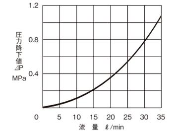
最低調整圧力-最大流量特性
