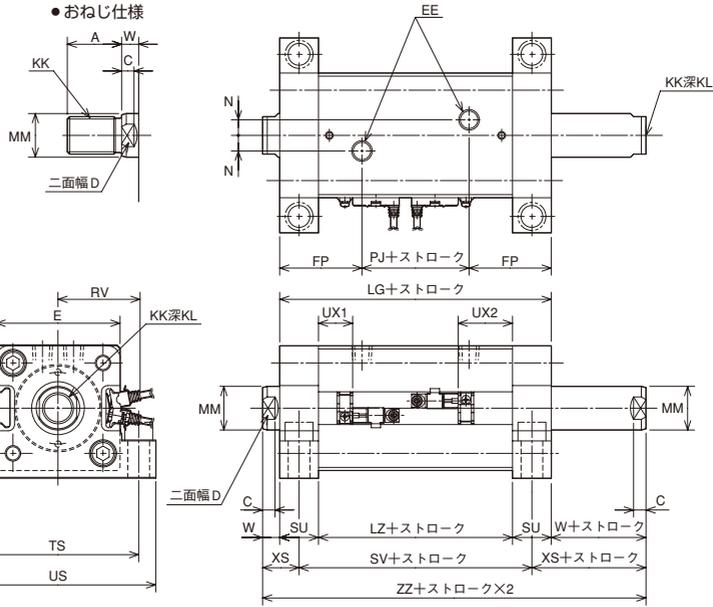
※接地面に取付ける場合は必ず六角穴付ボルトをご使用ください。
