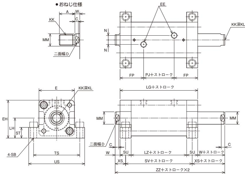
※接地面に取付ける場合は必ず六角穴付ボルトをご使用ください。
