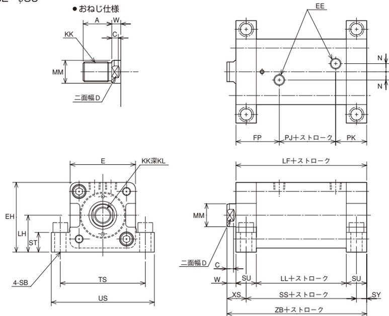
※接地面に取付ける場合は必ず六角穴付ボルトをご使用ください。
