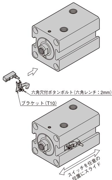
WR・WS形ブラケット固定ねじ締付トルク
