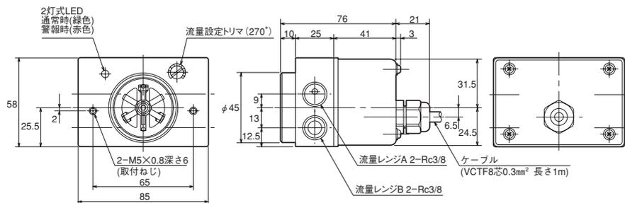
配管アダプタセット (DF-AP) 取付時寸法
