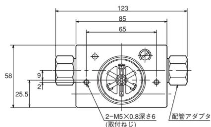
小流量配管アダプタセット (DF-FW2) 取付時寸法
