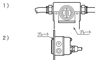
注意) 取付ねじ部は1.2~1.8N・mのトルクで締付けてください。
