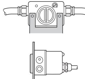
注)取付ねじ部は1.2~1.8N·mのトルクで締付けてください。
