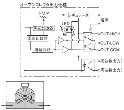
液体の流量に比例した回転数でロータが回転します。ロータの回転をボディ側のセンサで感知し、電気的パルス信号に変換します。このパルス信号はコイルによる起電と異なり、デジタルタイプのセンサを用いているため、ロータの回転数に関わらず常に一定の波高値の矩形波が得られる構造となっています。
