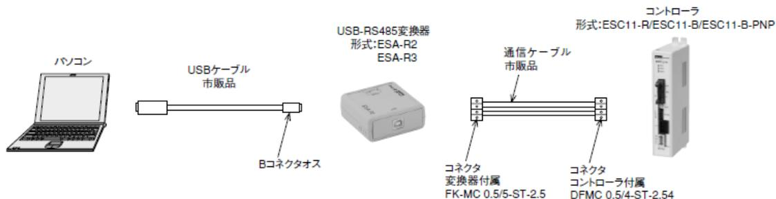
コントローラと変換器の接続は上図のように配線してください。
