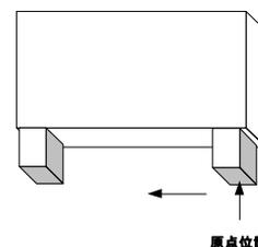
原点位置が開方向の場合、位置指定が+の場合は、閉方向へ移動します。
