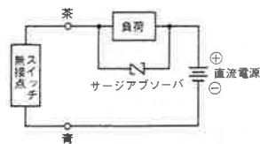
サージアブソーバ (バリスタ電圧DC30V) (以下)
