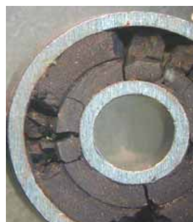
写真 3-1 クラックが発生したポペット部
