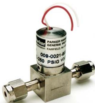
シリーズ9バルブは液体・気体の分析時における精密制御を対象とし、最高級の性能を発揮します。このバルブは小さいながら丈夫で、高速動作と大流量に対応し、再現性が極めて高いものです。このソレノイドバルブは非腐食性で不動態化したステンレスからできています。シリーズ9のコイルは連続通電が可能で、外部と接触しない方法で取り付けられています。
