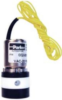
シリーズ2バルブはすべての接液部にPTFEを使用した2方向ソレノイドバルブです。平均寿命は1000万サイクル、電流損失が20%でも作動するので、重要な用途でも安心して使えます。すべてのバルブは出荷前に全数5万回の作動検査を行い、仕様書通りの最大性能が出るか確認しております。
