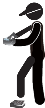
深穴の異物除去は フットバルブ ON でパルスブロー
