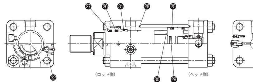
注) ロッド側はチェックボール式のクッション方式ヘッド側はフローティングクッション方式です。
