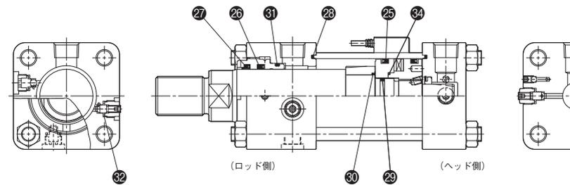
注) ロッド側はチェックボール式のクッション方式ヘッド側はフローティングクッション方式です。
