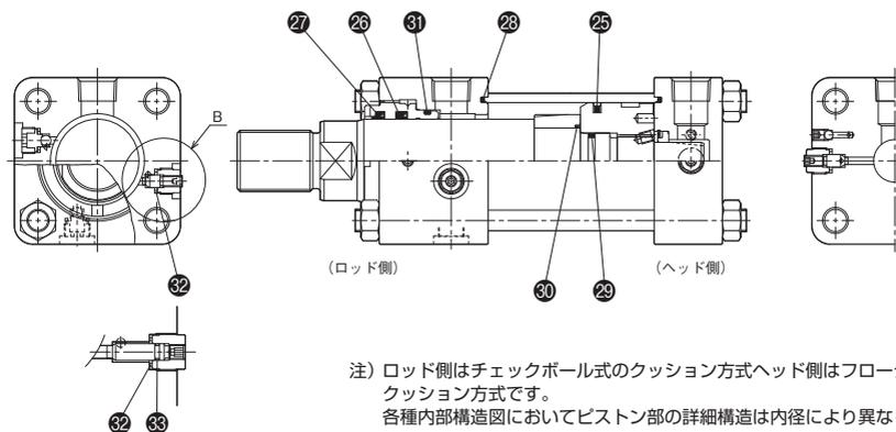
注) ロッド側はチェックボール式のクッション方式ヘッド側はフローティングクッション方式です。
